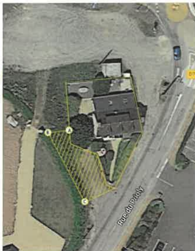
PROJET, qui consiste à déplacer les bornes A, B et C afin d'inclure le délaissé dans la propriété.
